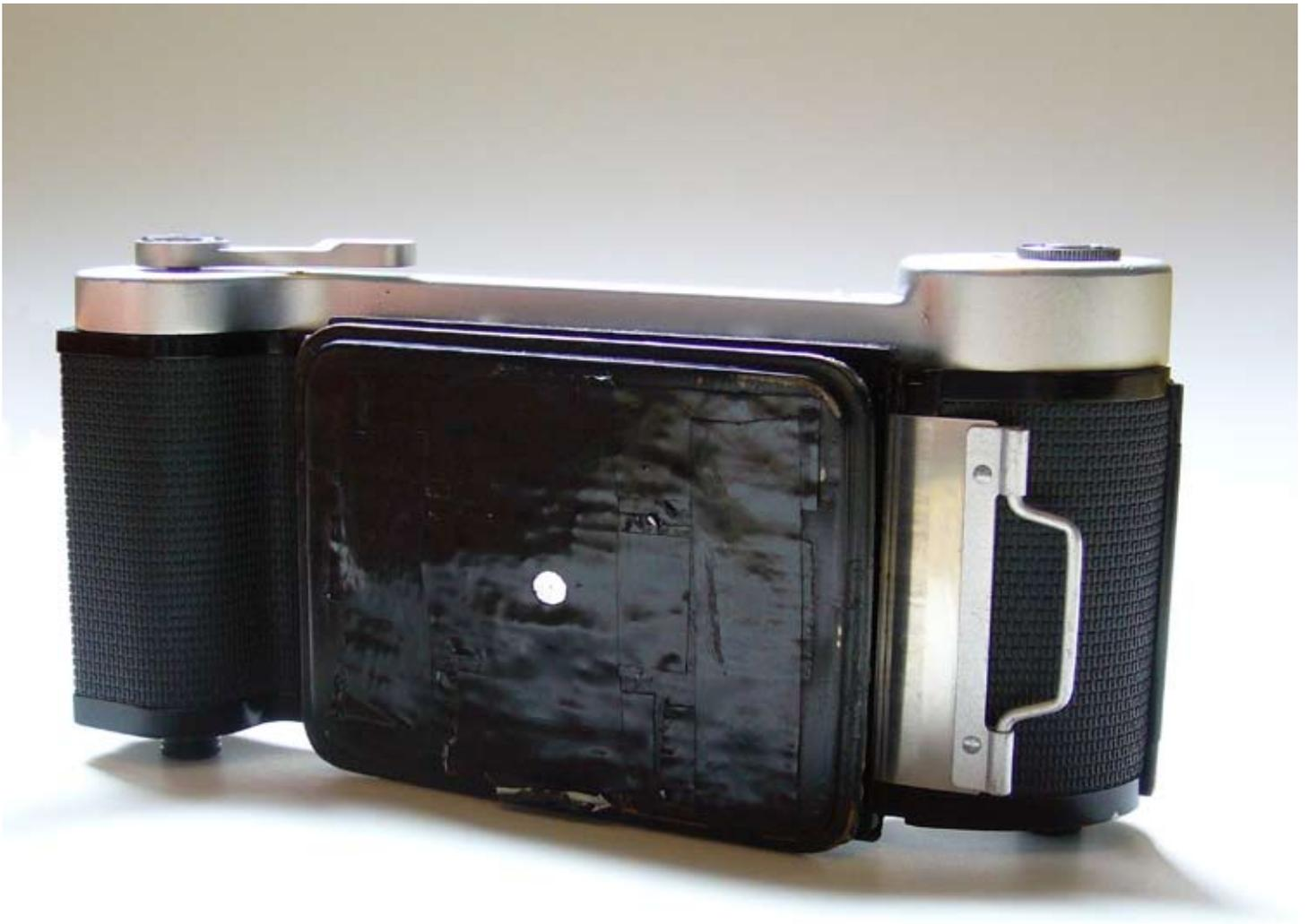
Dos d'appareil moyen-format Mamiya Press 6x9 et optique de fabrication artisanale (couverture de boîte de thé Twinings).
