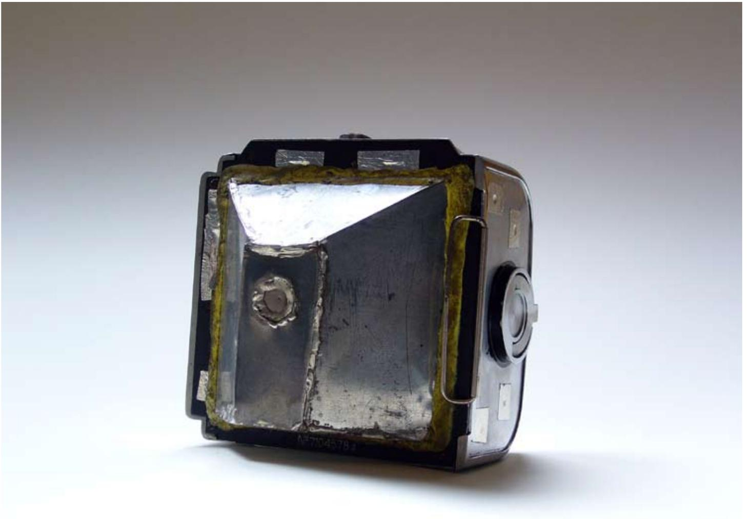
Dos d'appareil moyen-format Kiev 6x6 et optique de fabrication artisanale (plaques de fer blanc et soudure à l'étain).
